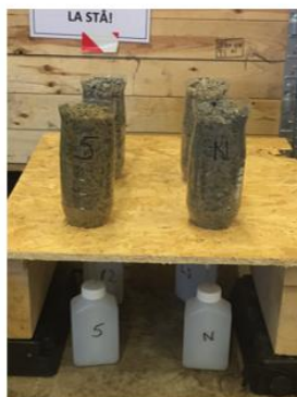
Umettede kolumnetester med gneissprøver (0-16mm).
