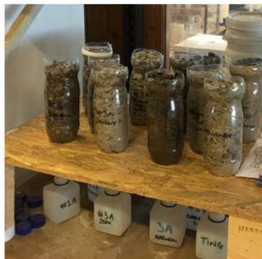
Umettede kolumnetester med gneissprøver (0-16mm).
