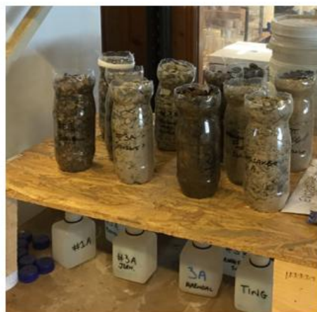
Umettede kollonnetester med gneisprøver (0-16mm).
