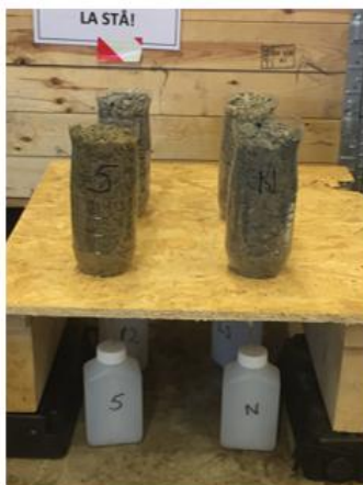
Umettede kollonnetester med gneisprøver (0-16mm).
